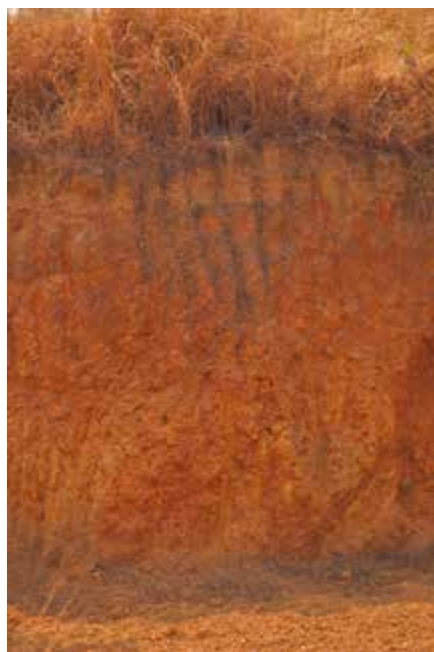
Figura 2.3.7 Perfil ferralítico que ilustra um solo desgastado, com a presença de pisolites (grãos concrecionários), e com uma formação escura de laterite na base. Wako Kungo, província de Cuanza Sul. Fotografia de António Martins.
